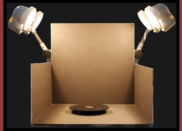
Estructura. Plataforma giratoria con sistema de iluminación para la captura fotográfica.
