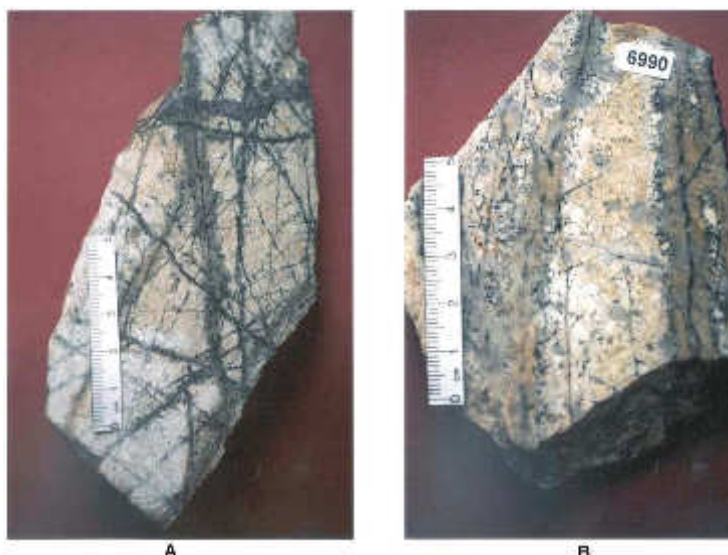
Figura 3. Muestra de roca mineralizada de un “stockwerk” de un pórfido cuprífero explotado en la actualidad . Foto cortesía del Profesor Francisco Munizaga, Universidad de Chile.
