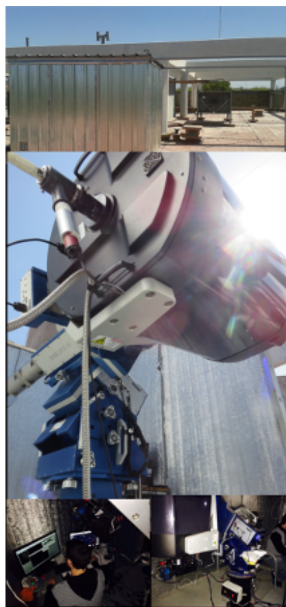
Figura 4: Telescopio Meade de 0.5 m y casilla de protección instalada en el techo del laboratorio. Este es un prototipo de las casillas que se emplearán en la montaña.
