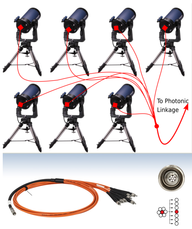
Figura 1: Panel superior: Idea general de un sistema económico de colectores múltiples. Panel inferior: Fibras ópticas en un arreglo “heptapack”.
