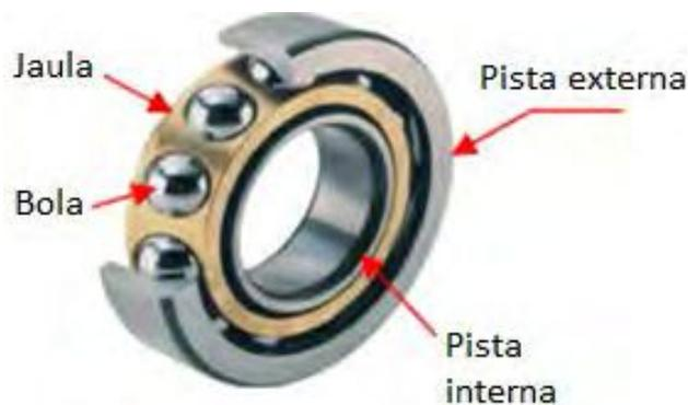
**Fig. 1** Diagrama esquemático rodamiento de una hilera de bolas de contacto angular, identificando las distintas partes que componen al mismo
