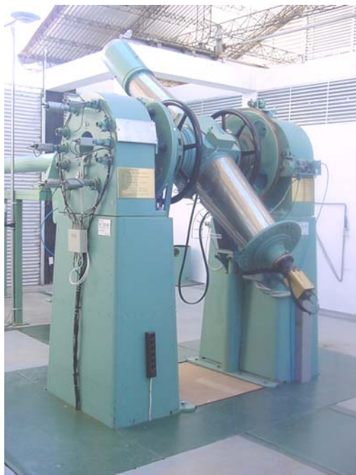
Figura 2. Círculo meridiano automático de San Fernando en el Observatorio C. U. Cesco, El Leoncito, San Juan, Argentina
