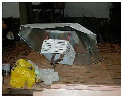
**Figura 6:** Resguardo meteorológico para el HOB0 de exterior
