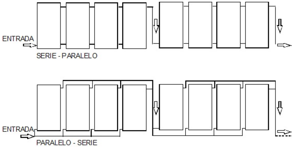
Figura 27: Forma de instalar colectores solares planos.
