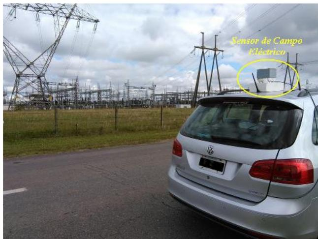
Fig. 2. Ubicación del sistema de medición usando SCE bajo línea de 220 kV.
