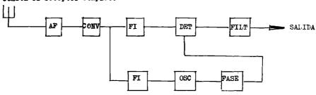
Las etapas de amplificación de alta frecuencia y conversora son convencioles, y tienen por finalidad amplificar y convertir la señal de antena en una
