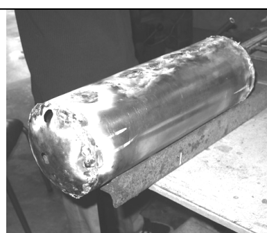
Figura 5: Proceso de soldado del tanque
